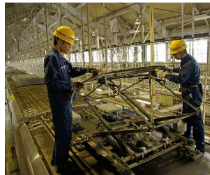
パンタグラフの点検
