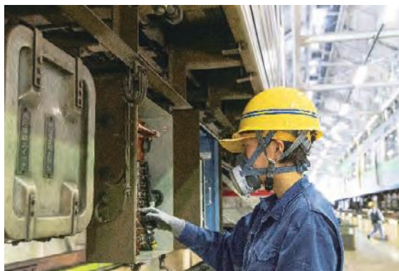
床下機器類の点検
